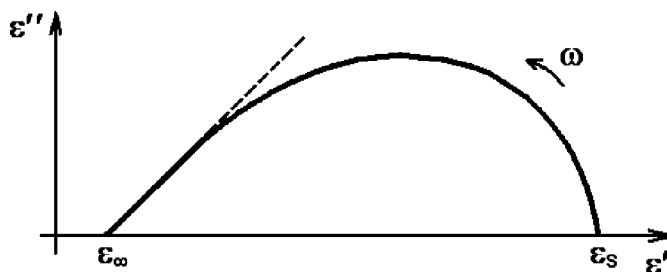
Obr. 2.21 Coleův-Davidsonův diagram s jedním distribučním parametrem [10]
