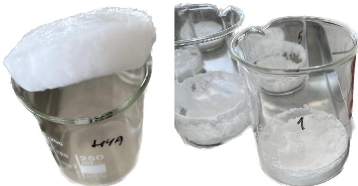
Obr. 16 Čistý hyaluronan po lyofilizaci (vlevo), lyofilizovaný systém hyaluronan s navázaným vzorkem 1 (vpravo).
