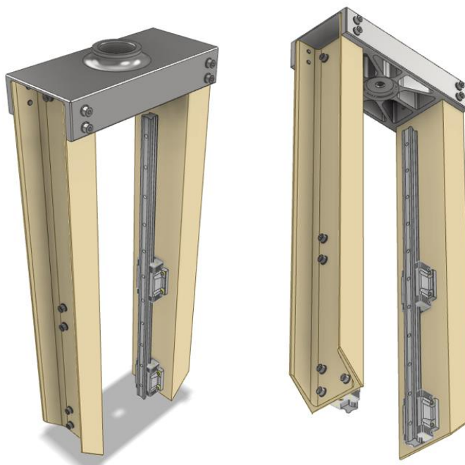
Obr. 36 Výsuvný stůl s uchycením pro adaptér tlumiče
