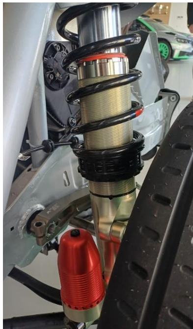
Obr. 11 Tlumič ZF na voze Fabia RS Rally 2
