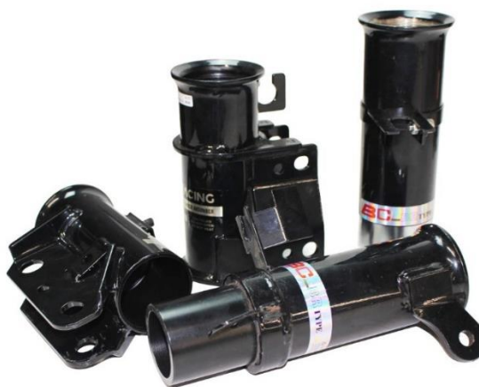
Obr. 5 příklady uchycení tlumičů [9]
