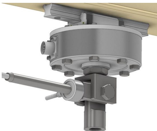
Obr. 31 Horní uložení tlumiče v zařízení
