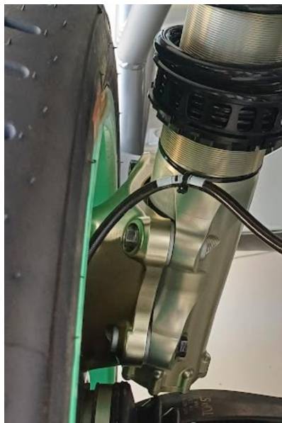
Obr. 4 uchycení vzpěry na vozu Fabia RS Rally 2
