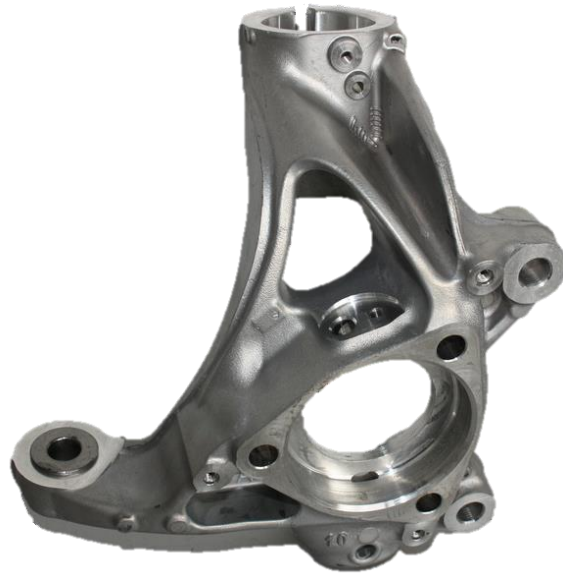
Obr. 3 Těhlice vozu Škoda Karoq [8]
