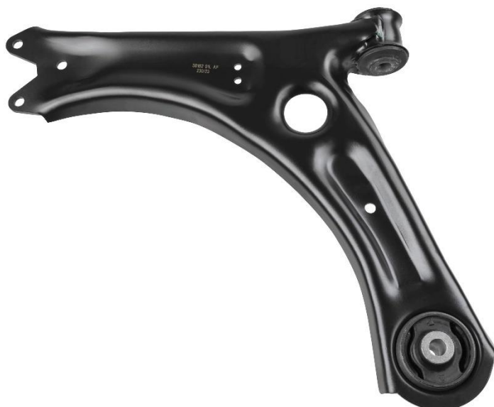
Obr. 2 kyvné rameno zavěšení [7]
