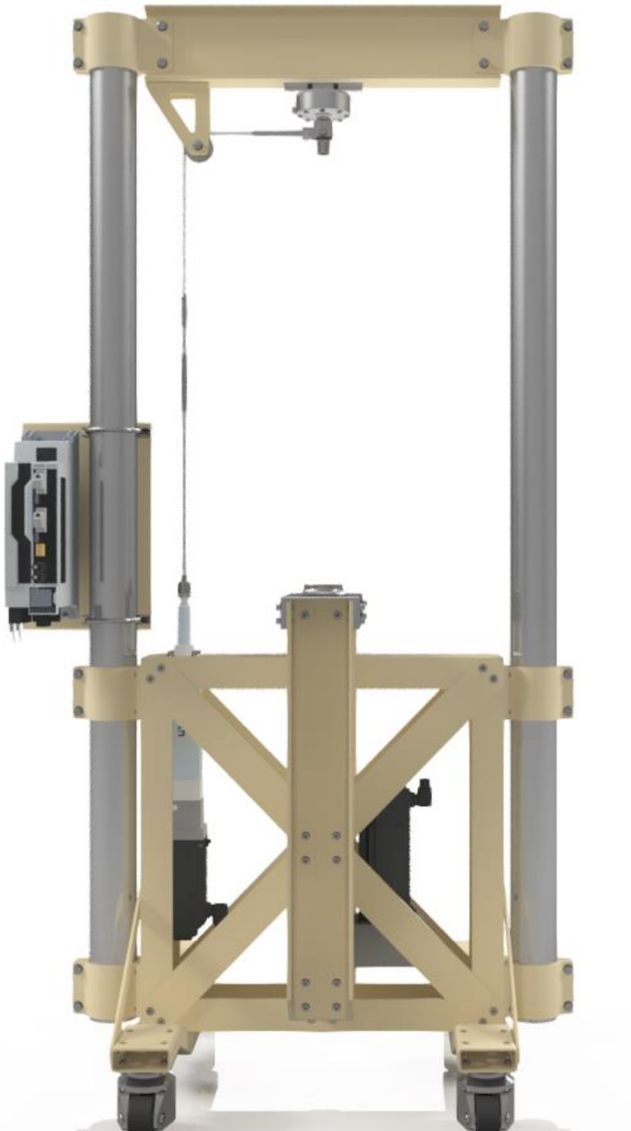
Obr. 30 Návrh konstrukce testovacího zařízení pro měření tření v tlumiči
