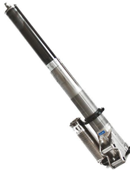
Obr. 9 Třítrubkový tlumič EXT WRC [11]
