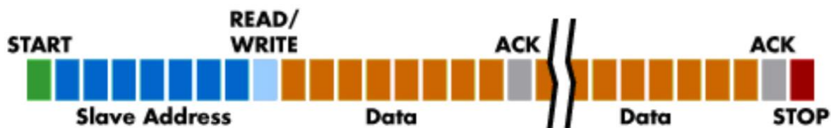
Obrázek 22: Schéma přenosu dat po sběrnici [15]
