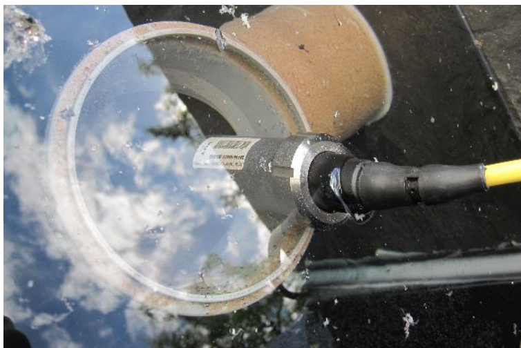
Obr. 39 Detail umístění měřicí sondy do kolene potrubí DN 110
