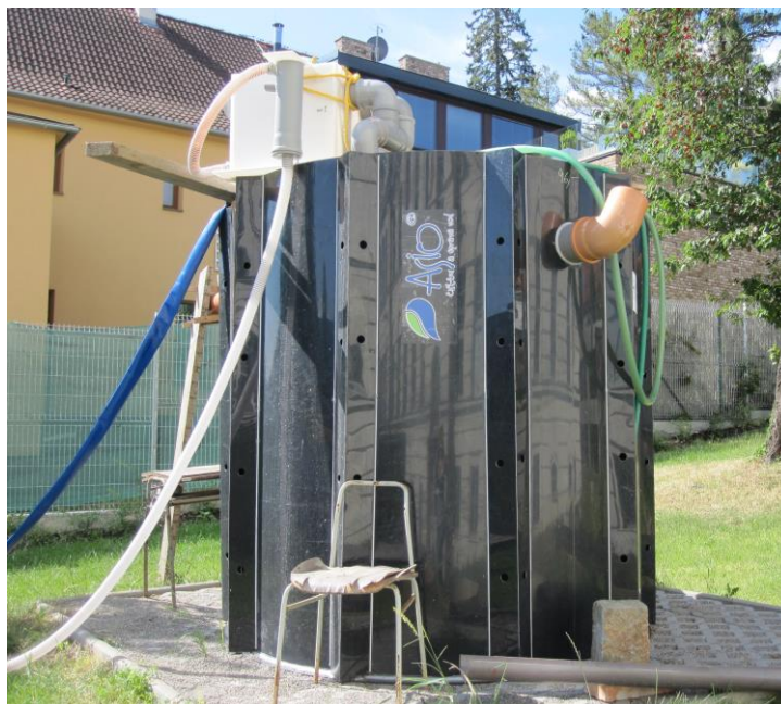
Obr. 20 Pohled na nově vyvíjený čtyř komorový septik
