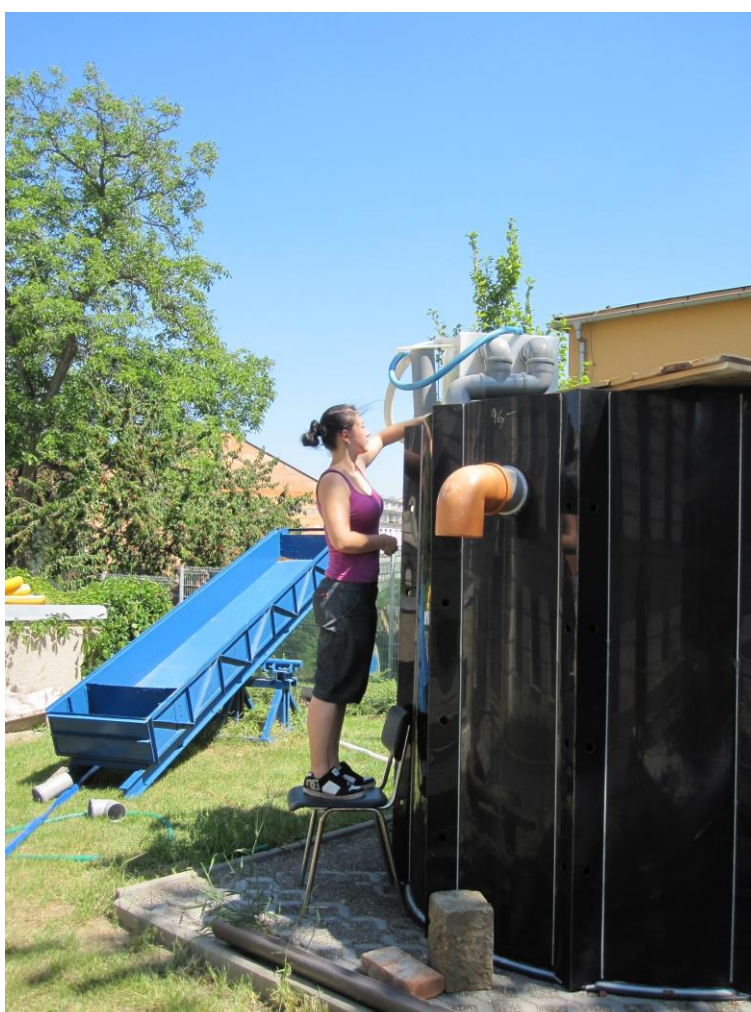
Obr. 36 Odběr vzorku z potrubí přepadu ze šachty
