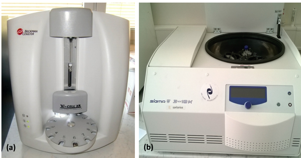
Obrázek 11: Přístroje pro měření životnosti buněk a centrifugaci: a) Vi-CELL XR; b) SIGMA 3-18K Centrifuge; © M. Šafářová
