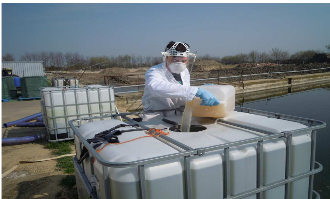
Foto č. 5: Aplikace biopreparátu do přípravných nádrží H2 a V2 (Vymazal, 2014).
