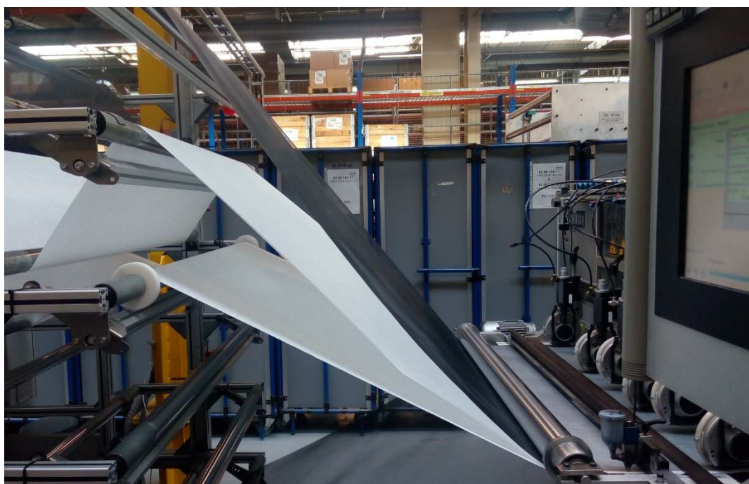
Obr. 8: Pleating – nasouvání filtračního papíru a kovové mřížky do stroje
