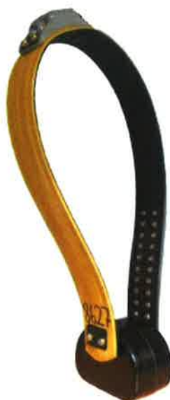
Obrázek 7 GPS telemetrický obojek, kterým byla označena černá zvěř.
