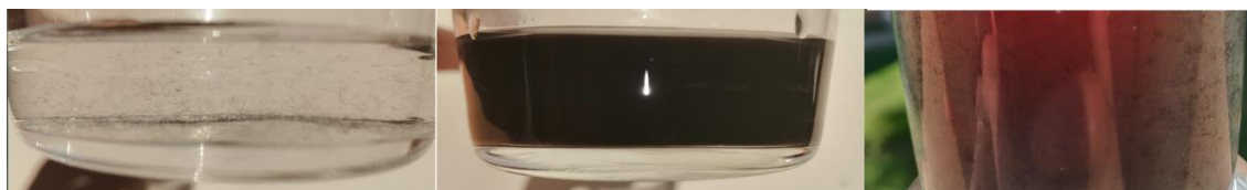
Obr. č. 37 Zleva: nádoba s destilovanou vodou po promytí NEkompostovaného vzorku, nádoba s destilovanou vodou po promytí kompostovaného vzorku, nádoba se zředěnou destilovanou vodou po promytí kompostovaného vzorku
