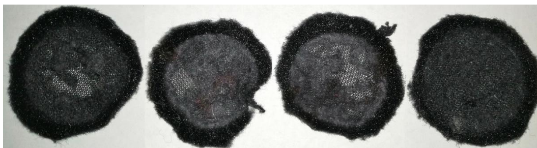
Obr. č. 27 Vzorky konv. fleecu, po oděru zleva nevypraný vzorek, 2 krát, 4 krát a 6 krát vypraný vzorek
