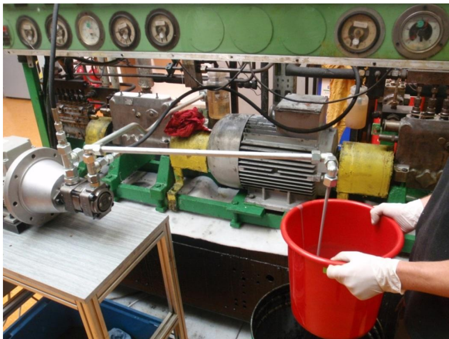
Obrázek 34 – Měření hmotnostního průtoku zubového čerpadla Bucher QXV 25
