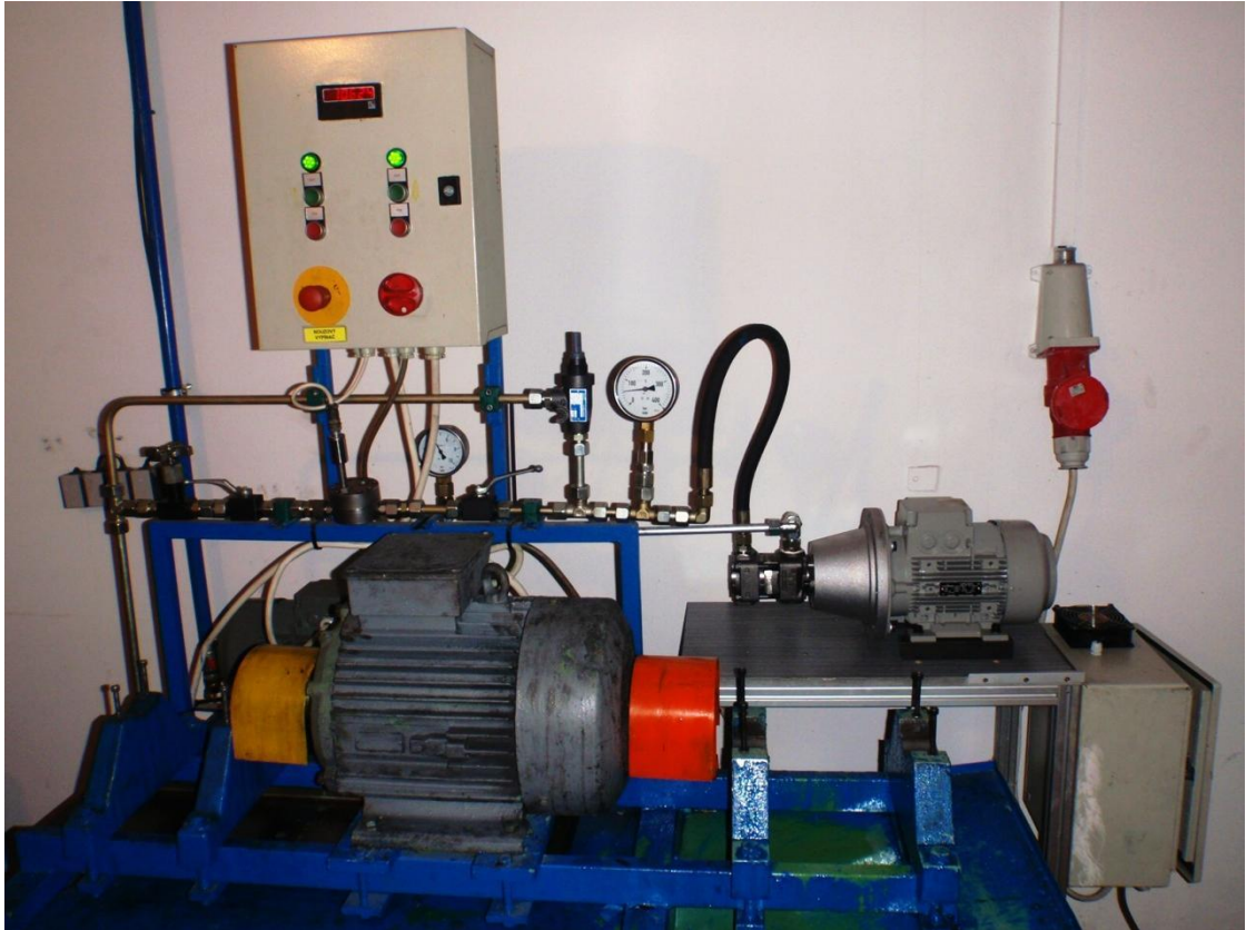
Obrázek 30 – Zubové čerpadlo Bucher QXV 25 připojené na zkušební stolicí
