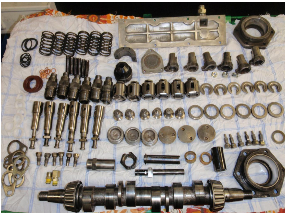
Obrázek 8 – Jednotlivé díly řadového pístového čerpadla Bosch ZW 160
