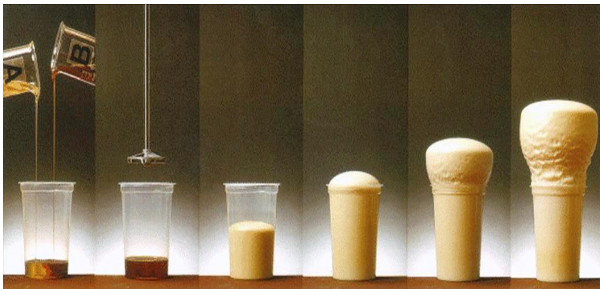
Obrázek 2 – Fotografické znázornění reakce složek polyuretanu [1]
