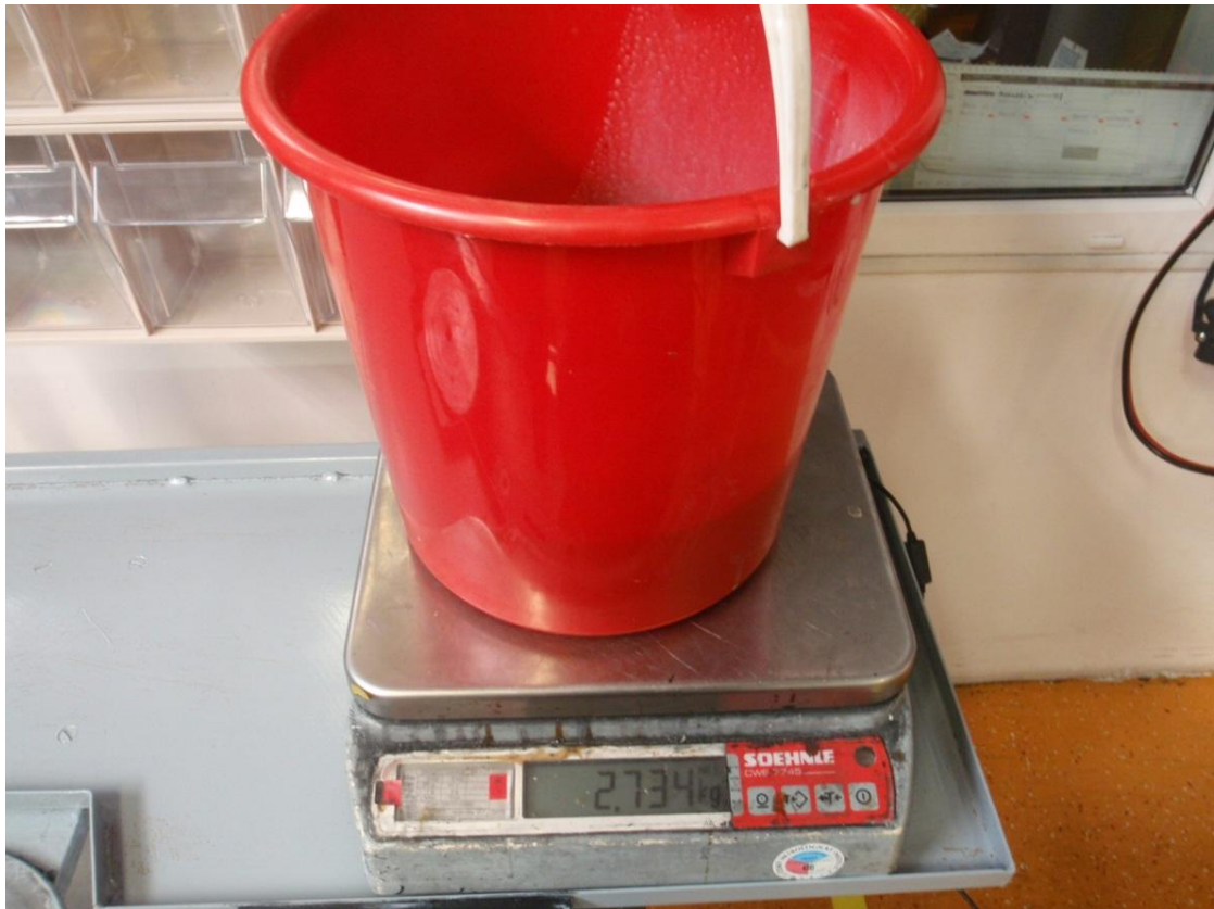
Obrázek 35 – Měření hmotnostního průtoku čerpadla Bucher QXV 25 na digitální váze
