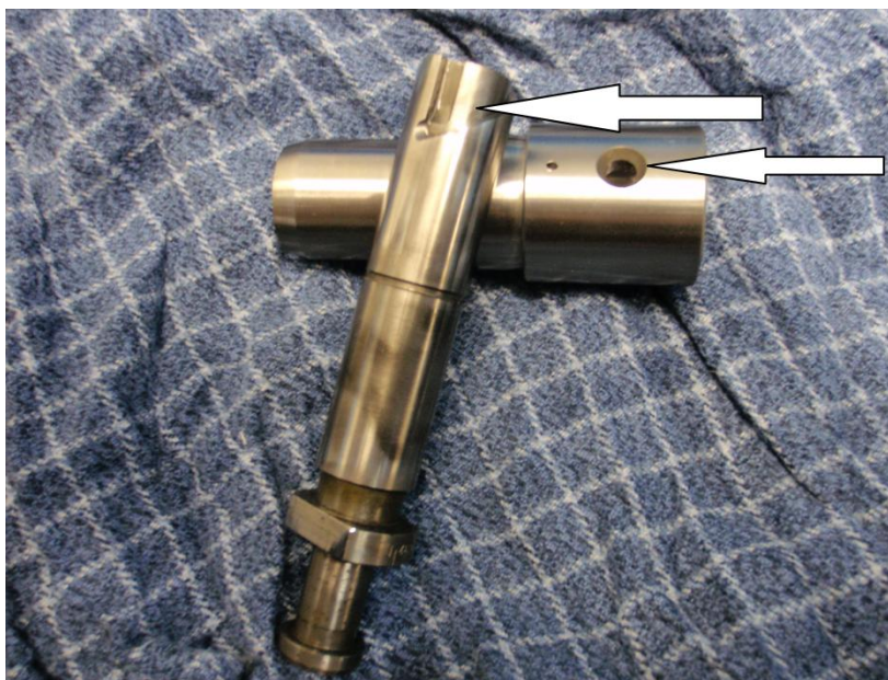
Obrázek 7 – Zobrazení regulační hrany pístu a plnicího otvoru
