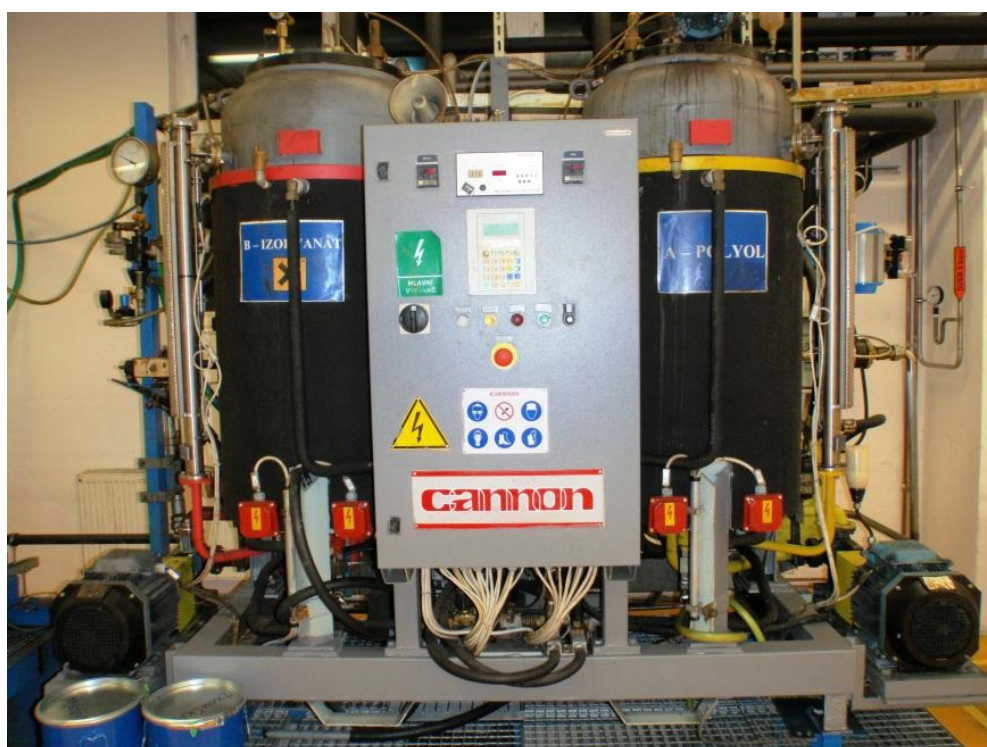
Obrázek 3 – Denní zásobníky se sycením polyolu dusíkem
