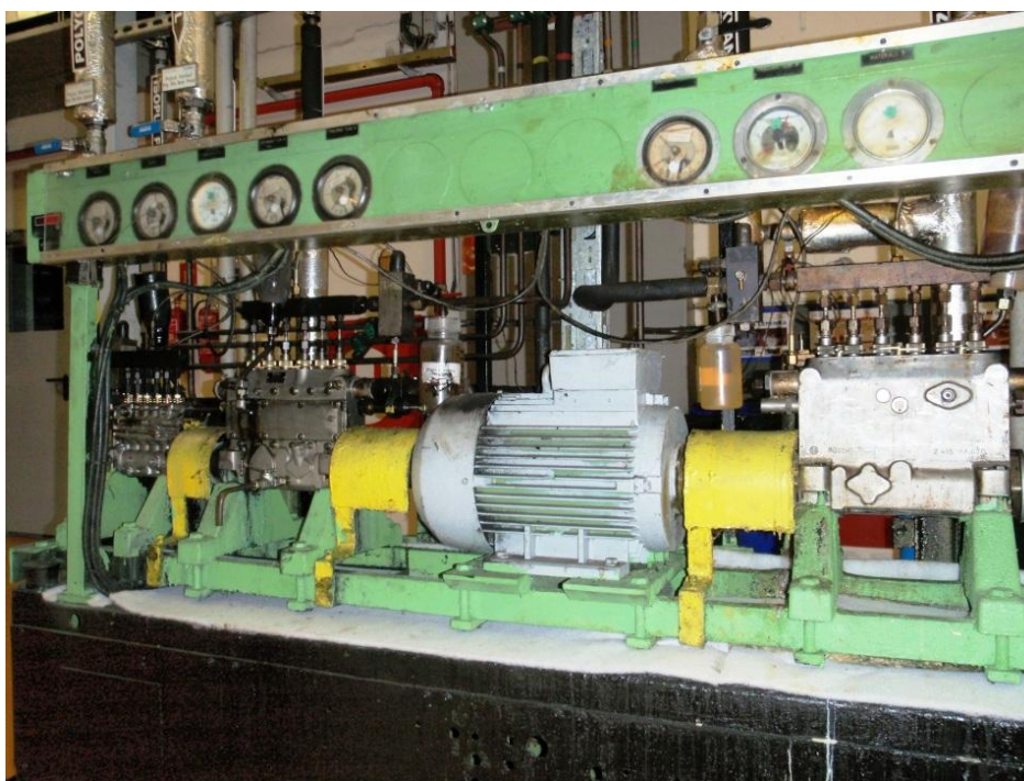
Obrázek 24 – Původní technologie s řadovými pístovými čerpadly Bosch
