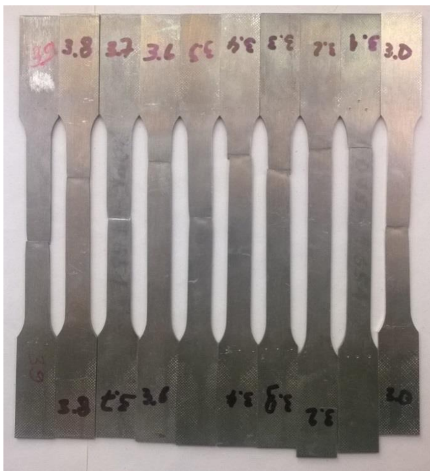
Obrázek 17: Sada vzorků slitiny 7075 po provedení tahové zkoušky. Čas vytvrzování roste zprava doleva
