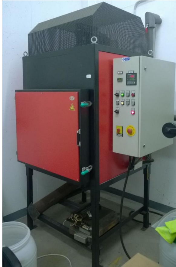
Obrázek 14: Laboratorní elektrická pec užitá pro tepelné zpracování.
