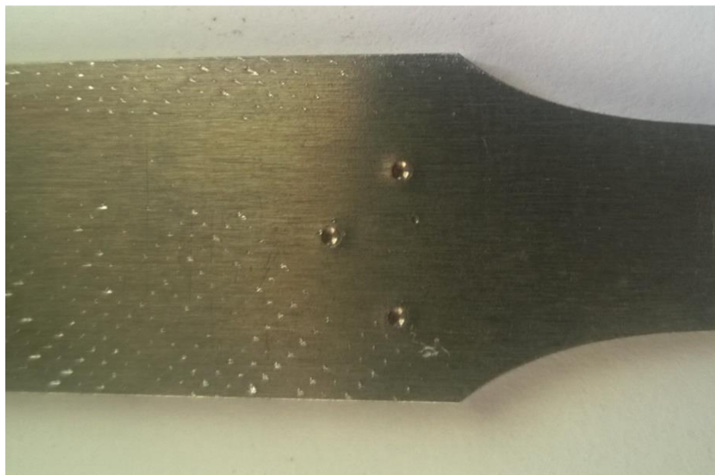
Obrázek 15: Detail umístění vrypů po měření pevnosti.
