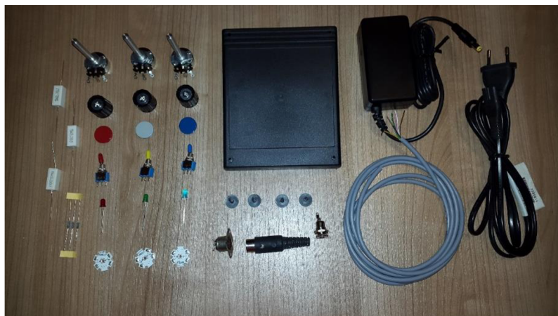
Obr. 19 Nakúpené komponenty pre elektrickú časť
