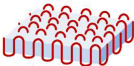
Obr. č.5: Schematický pohled na lamelu s vertikálně uspořádanými krystalickými oblastmi
