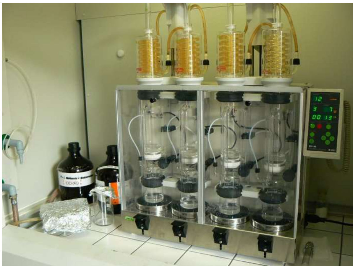
Obr. 24 Extraktor Büchi pro analýzu PAHs v imisním monitoringu ČHMÚ na pobočce Ústí nad Labem (Archiv ČHMÚ)
