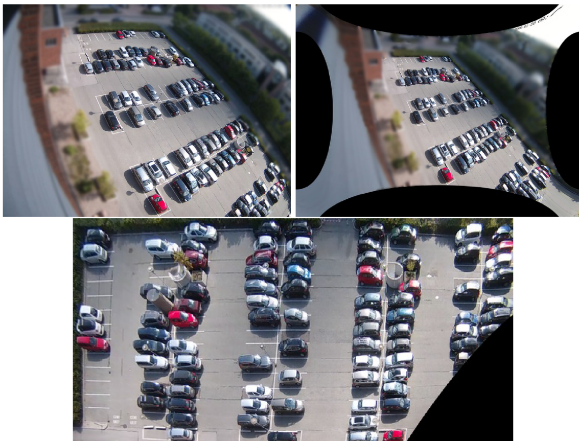
Obrázek 3.5: Původní snímek (vlevo nahoře), snímek po odstranění radiální distorze (vpravo nahoře) a snímek po odstranění perspektivy (dole)
