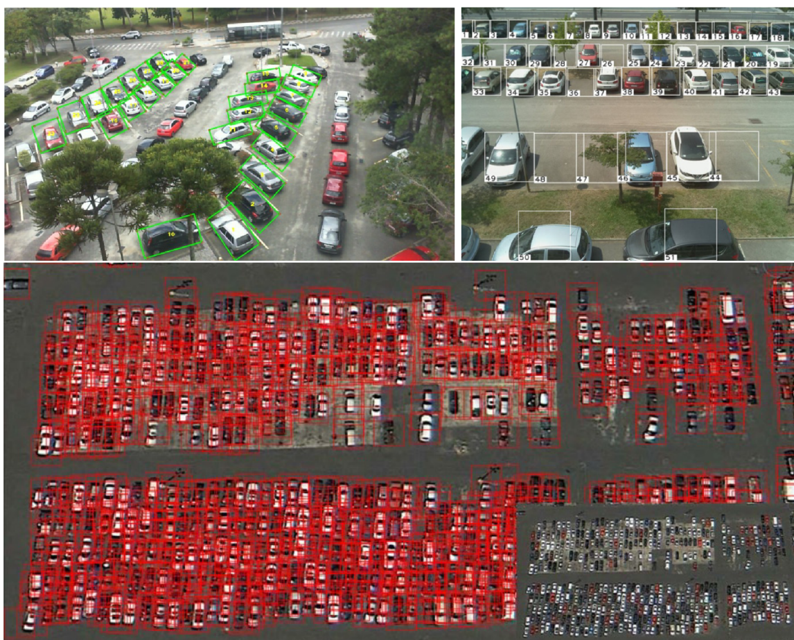
Obrázek 2.1: Označení parkovacích míst a automobilů v metodách s konvoluční neuronovou sítí. Převzato z [3], [22] a [9].
