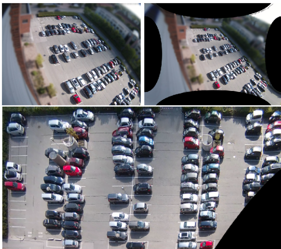
Obrázek 2. Původní snímek, snímek po odstranění distorze a snímek po odstranění perspektivy
