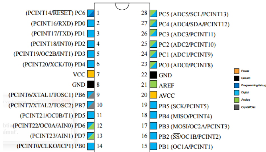
Obrázok 8: Rozloženie pinov na ATmege328 pre puzdro PDIP (prevzaté z [2]).
