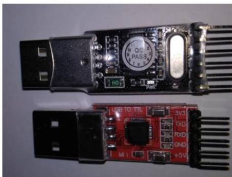
Obrázok 16: Prevodníky USB to TTL CP2102 (červený) a CH340G.
