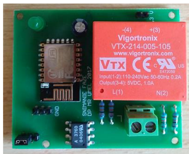
Obrázok 27: Osadená DPS - detekcia fáze.
