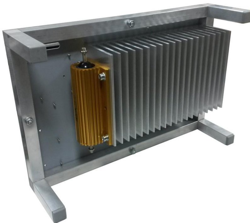
Obr. 7.1: Nosná konstrukce střídače
