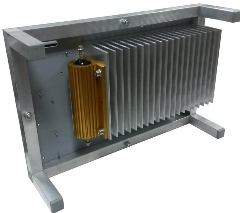
Obr. 7.1: Nosná konstrukce střídače
