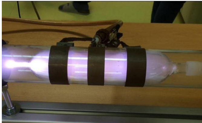
Obrázok 17: Sklenená banka naplnená vláknami počas plazmovania
