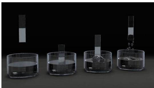
Obr. 15 Postup techniky „dip-coating“
