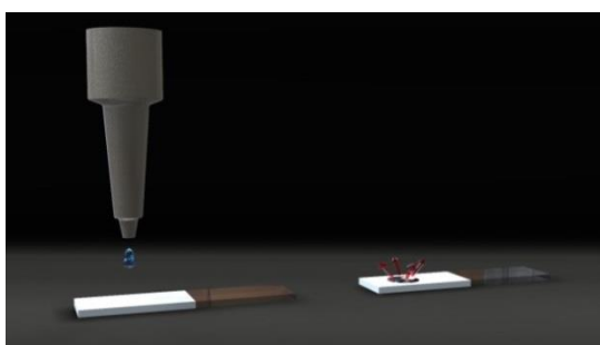
Obr. 16 Postup techniky „drop-casting“
