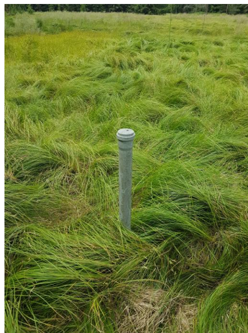
Obr. č. 2: Perforovaná trubka k měření hloubky podzemní vody (foto: autor)
