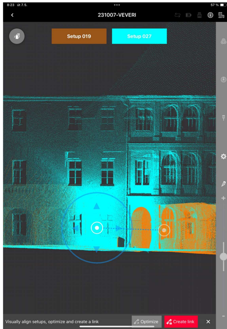
Obrázek 18 - Ukázka napojení stanovišek metodou cloud to cloud Leica FIELD 360
