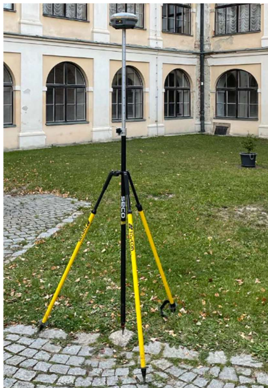
Obrázek 16 - Ukázka upevnění přijímače Trimble R8s při měření
