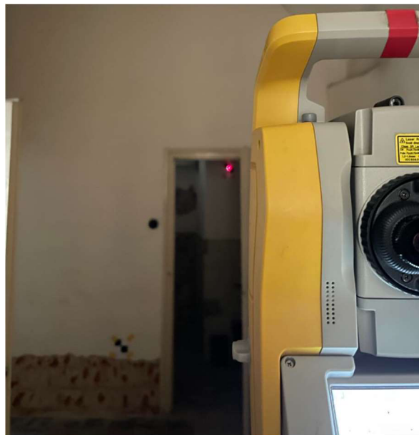
Obrázek 17 - Ukázka zaměření vlíčovacích bodů
