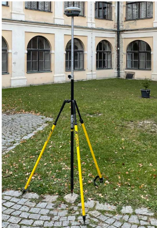
Obrázek 16 - Ukázka upevnění přijímače Trimble R8s při měření
