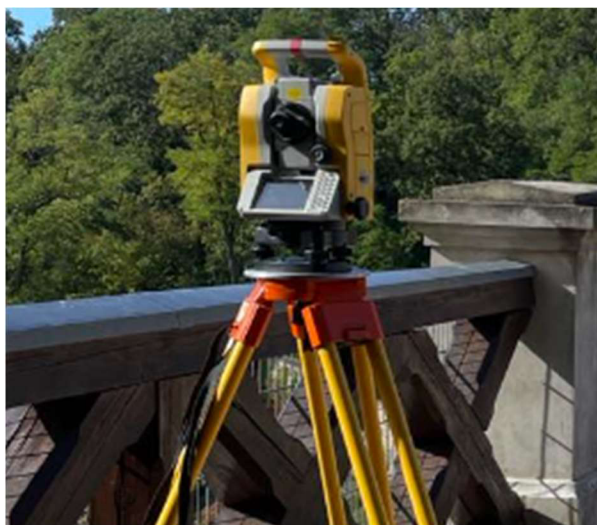
Obrázek 12 - Totální stanice Trimble M3
