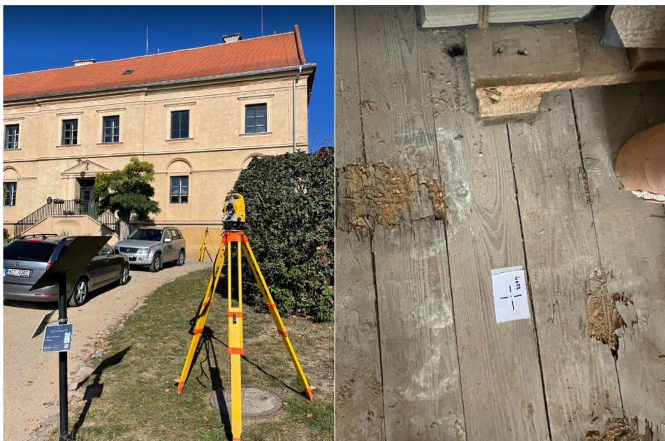
Obrázek 10 - Ukázka dočasné stabilizace bodů pomocné měřické sítě
