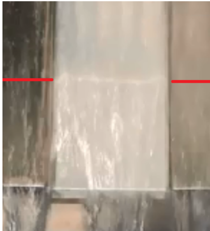
Obr. 4.11: Fotografie stékající vody, která díky nerovnoměrnému rozložení teplot a LF efektu, smáčí pouze horní část hliníkové desky
