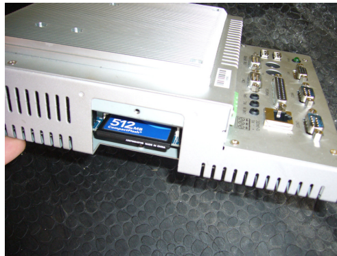
Obr. 22: Záznamové médium (SD karta) umístěné v průmyslovém PC
