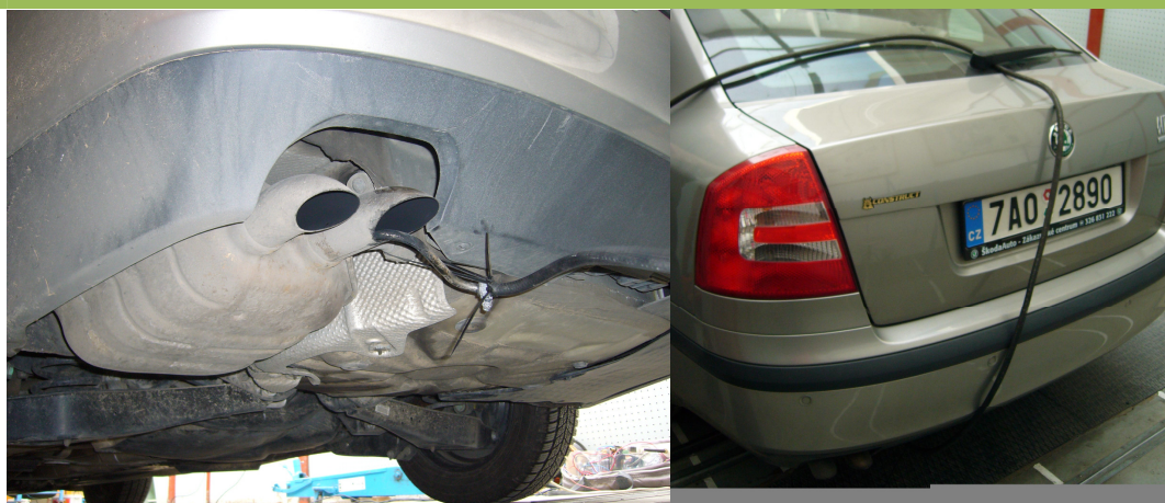
Obr. 20: Instalace výfukové hadice
