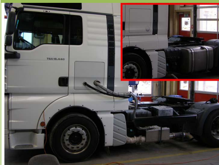
Obr. 16: Demontáž nádrže a umístění analyzátoru
