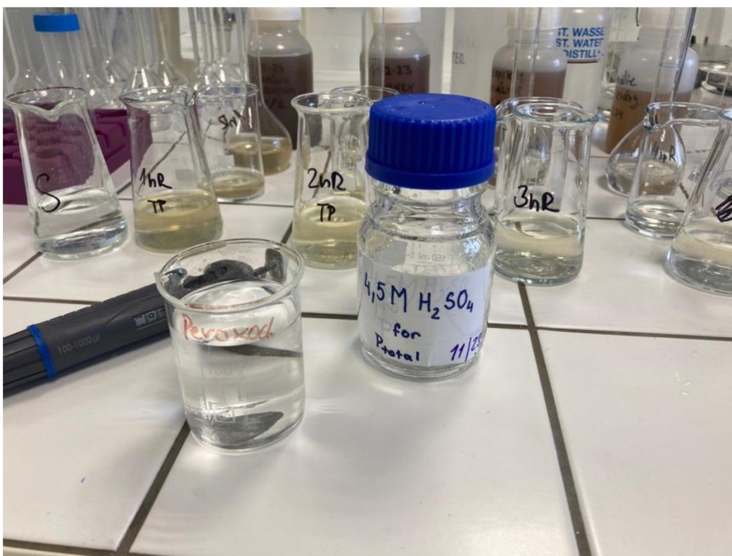
Obrázek 15: Stabilizace fosforu ve vzorcích pomocí kyseliny H 2 SO 4 (foto autor).
