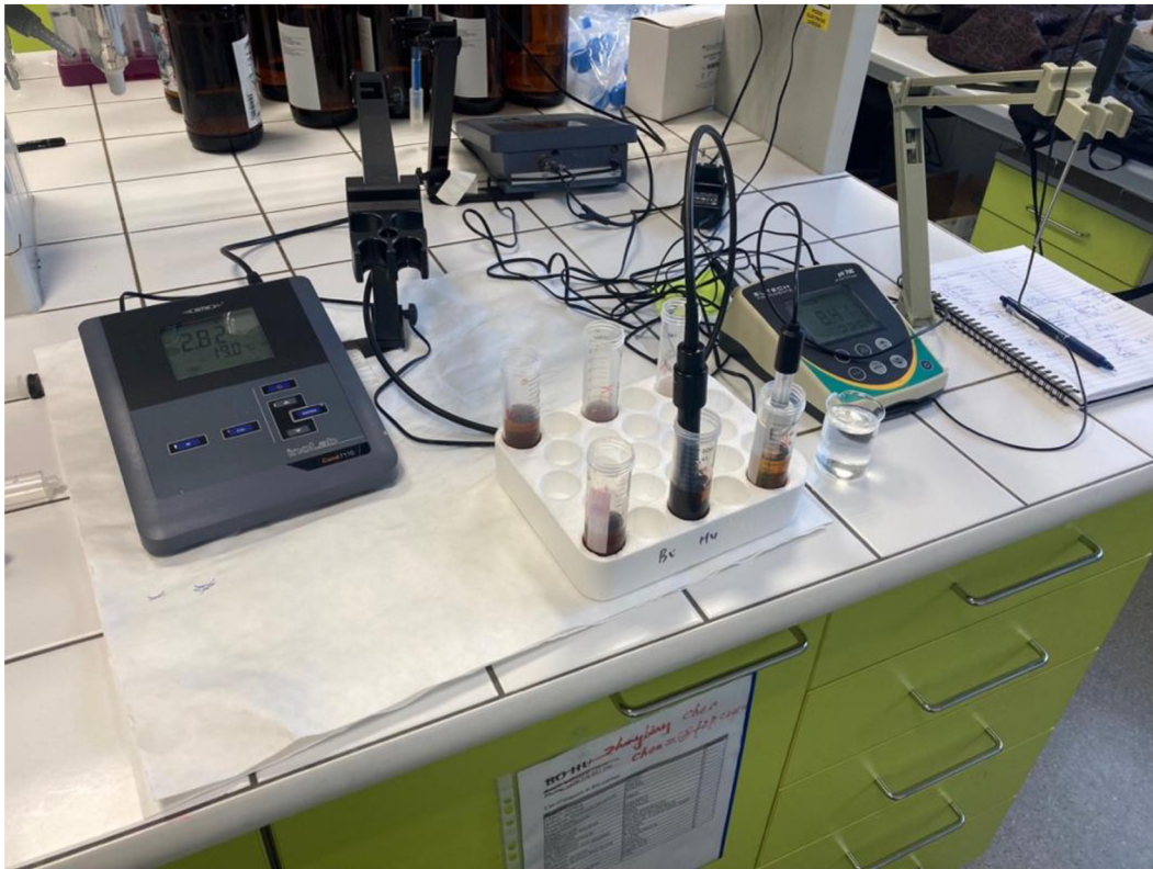
Obrázek 12: Měření vzorků smyvu na konduktometru a pH metru (foto autor).
