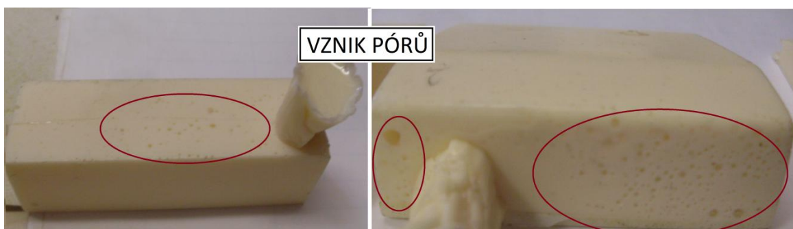
Obr. 3.34 Viditelné vady způsobené při odlévání součástí.
