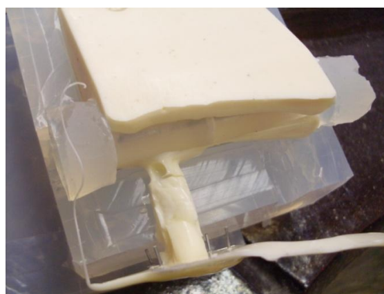
Obr. 3.33 Neúplné odlití zadní spojky.
