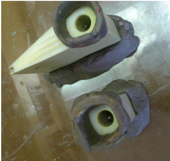
Obr. 3.22 Vymodelované nálitky a vodící tyčinka v modelu.
