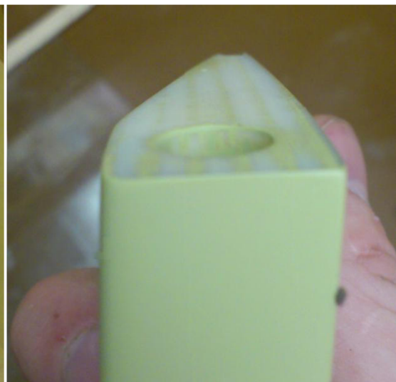
Obr. 3.21 Boční plocha po konečné úpravě.
