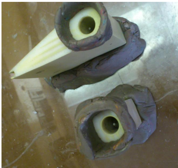
Obr. 3.22 Vymodelované nálitky a vodící tyčinka v modelu.
