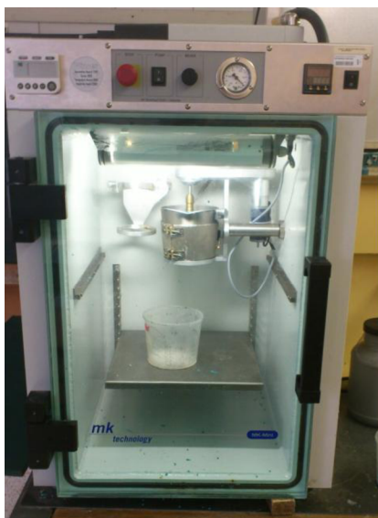
Obr. 3.17 Vakuová komora MK-Mini.
