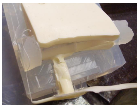
Obr. 3.33 Neúplné odlití zadní spojky.
