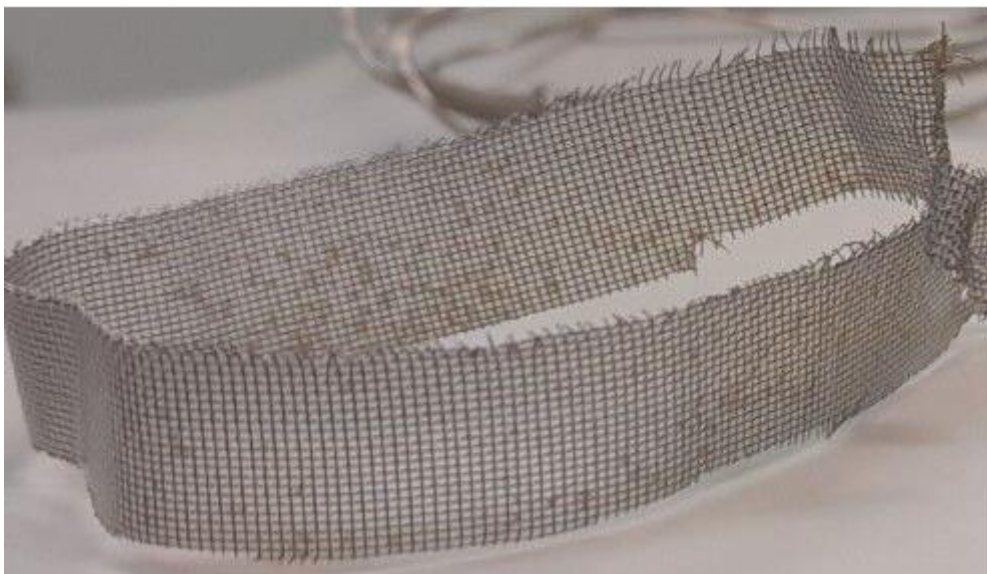
Obrázek 30, ocelová mřížka, pracovní elektroda v novém elektrodovém systému
