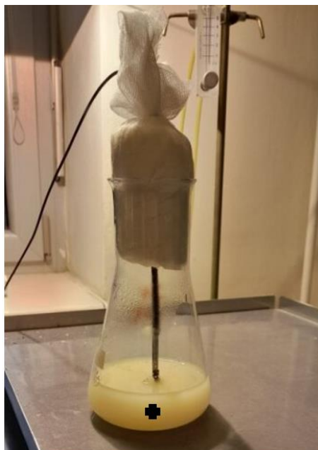
Obrázek 16, měření koncentrace O_2 v průběhu kultivace, černý křížek označuje umístění snímací části senzor
