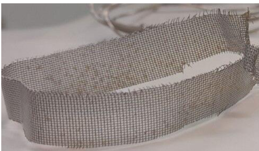
Obrázek 30, ocelová mřížka, pracovní elektroda v novém elektrodevém systému
