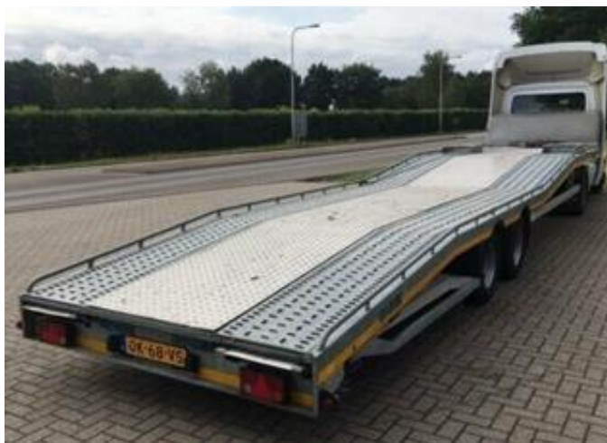
Obr. 4 Jednoplášinový návěs s celkovou hmotností 8500 kg s plechovou podlahou. [25]
