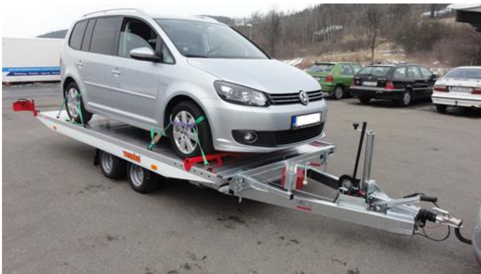
Obr. 3 Autopřepravník Vezeko Imola s ukotveným přepravovaným automobilem pomocí textilních popruhů. [24]
