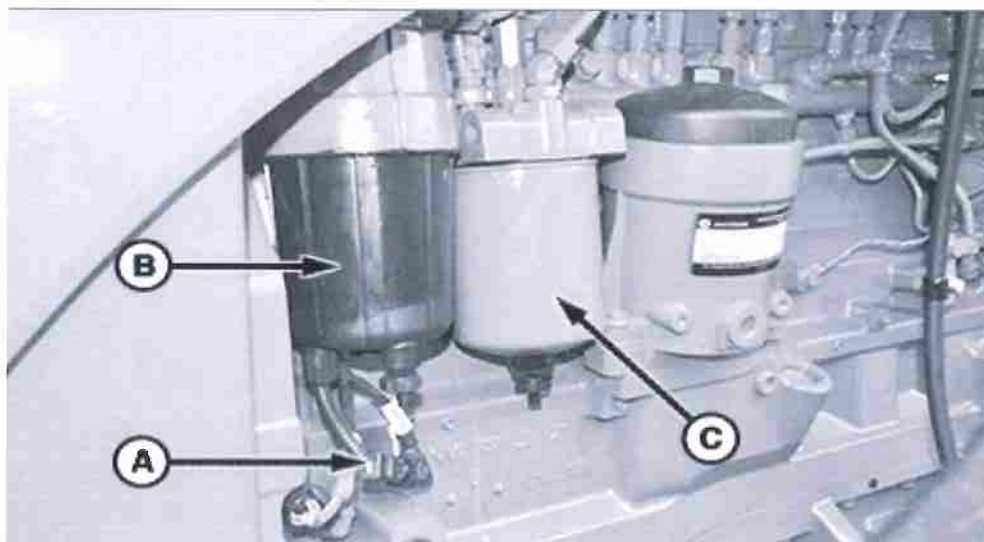
Obrázek č. 2 - Palivový čistič se snímačem obsahu vody v palivu, zdroj: SERVICE ADVISOR (2018)
