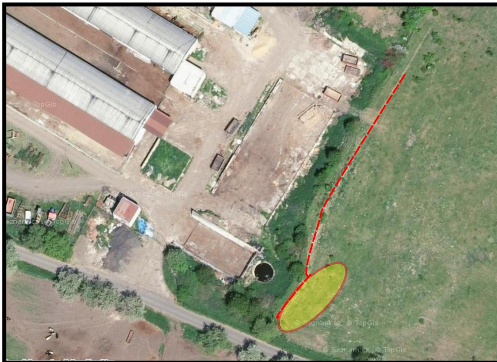
Obr. 47: návrh vodohospodářského opatření, detail: záchytný příkop OP a rozlivová plocha VN, Inkscape (autor, 2018)
