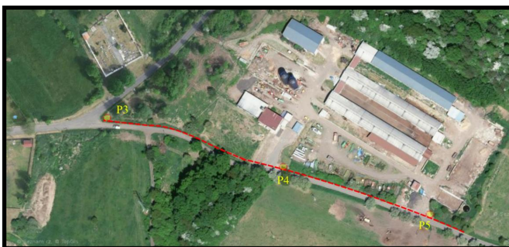
Obr. 48: návrh vodohospodářského opatření, detail: OP - záchytný příkop, P - propustky Inkscape (autor, 2018)
