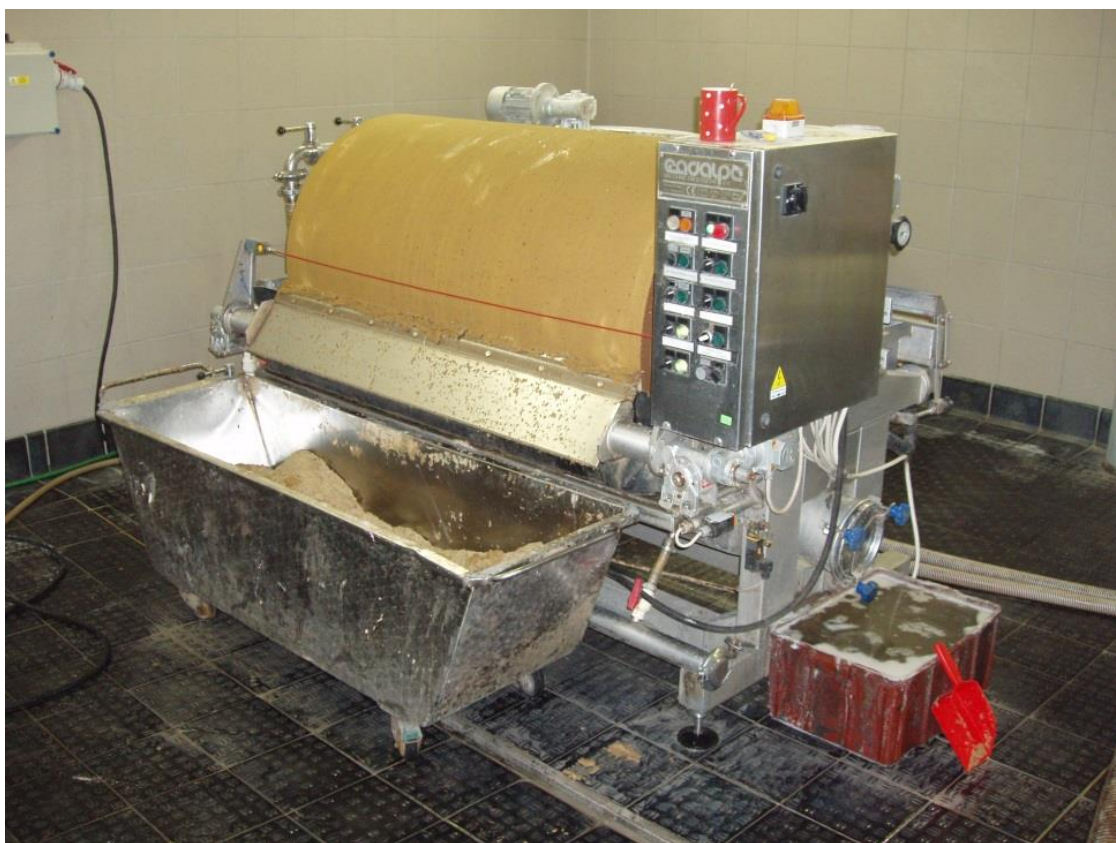
Obr. 7 vakuový rotační filtr (BURG, P. - ZEMÁNEK, P. 2013)
