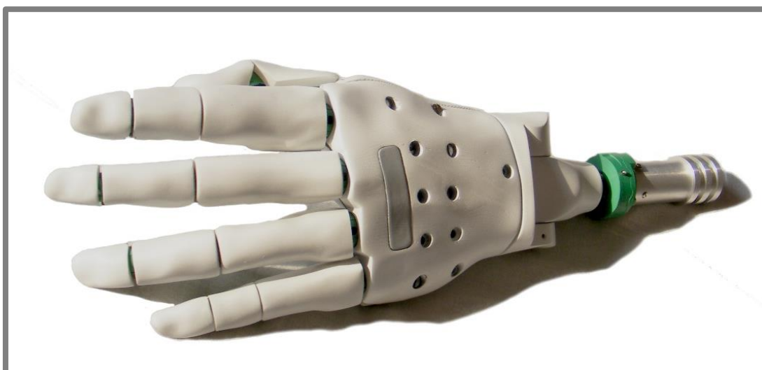
Obr. 5.27 Sestavená protéza bez lůžka a krytu předloktí
