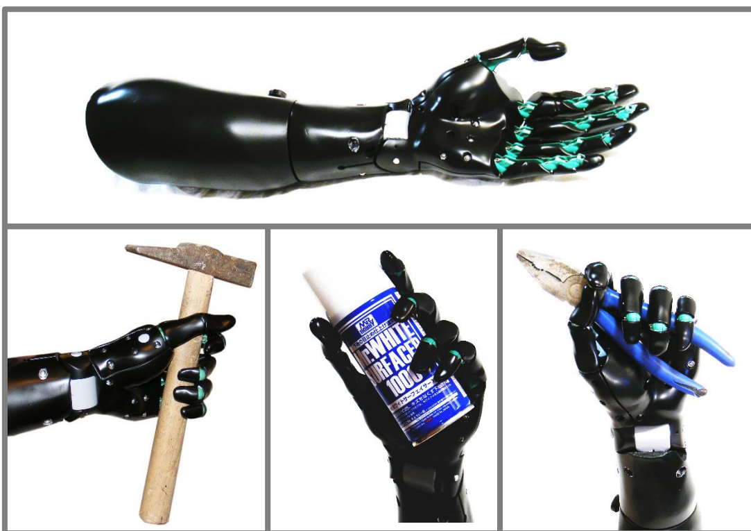
Obr. 5.32 Testování úchopu s protézou bez rukavice
