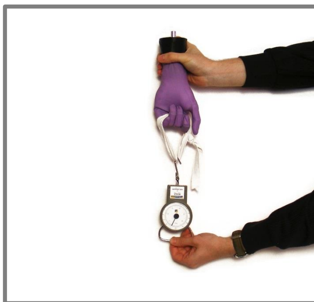
Obr. 5.31 Test maximální zátěže u háčkového úchopu
