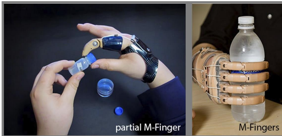
Obr. 2.19 Protéza pro částečné amputace M-Finger [26]
