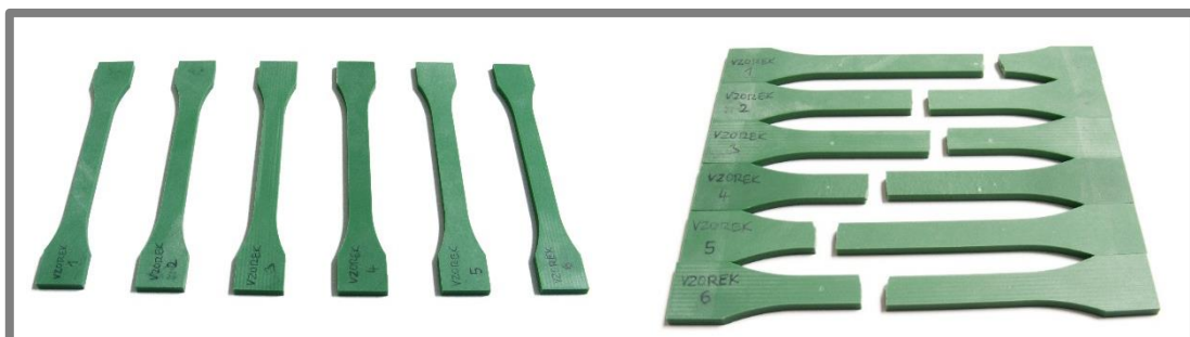
Obr. 5.15 Vzorky z materiálu SIKA M940 před a po tahové zkoušce
