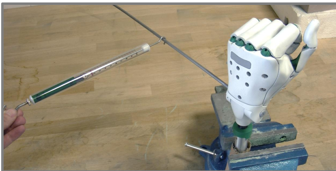
Obr. 5.30 Měření momentu potřebného k uvolnění předloktí z aretace
