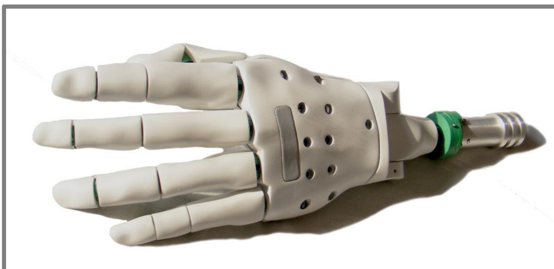
Obr. 5.27 Sestavená protéza bez lůžka a krytu předloktí
