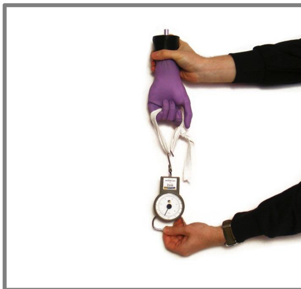
Obr. 5.31 Test maximální zátěže u háčkového úchopu
