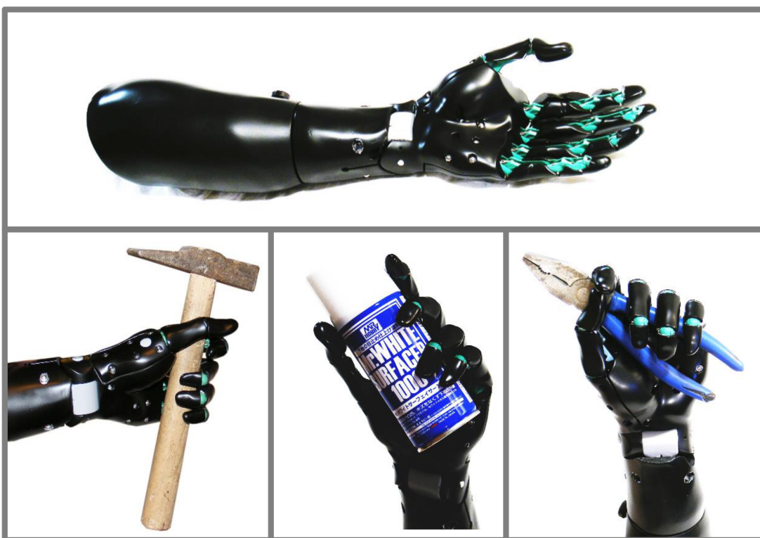
Obr. 5.32 Testování úchopu s protézou bez rukavice
