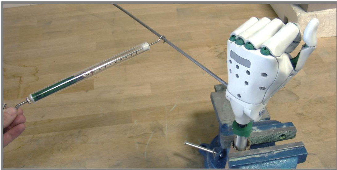
Obr. 5.30 Měření momentu potřebného k uvolnění předloktí z aretace
