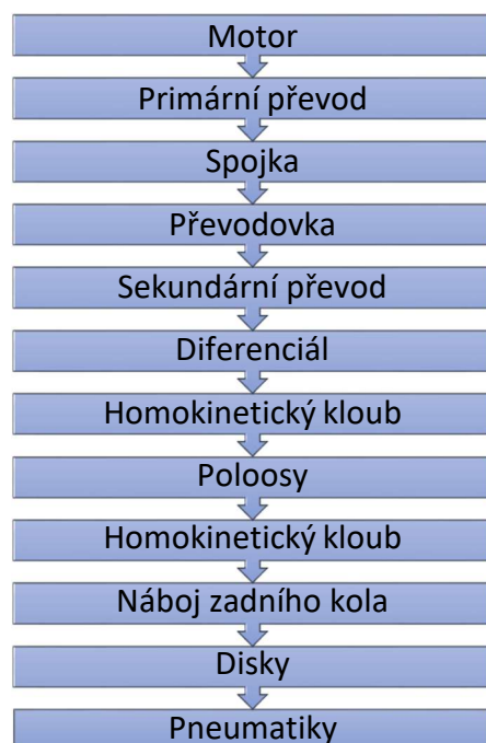
Obrázek 2 Základní schéma přenosu výkonu [archiv autora]
