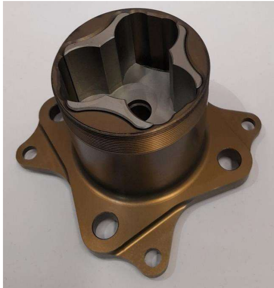
Obrázek 32 vyrobený náboj s vlisovanou vložkou z hliníkové slitiny [archiv autora]
