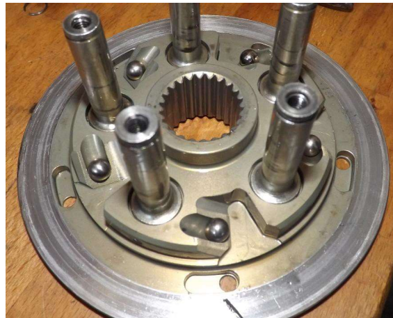
Obrázek 4 vlevo vnější pohled na spojku TSS vpravo detail vnitřní konstrukce antihoppingové spojky, jsou zřetelně vidět kuličky umístěné na rampách které slouží k částečnému vystavení spojky [13;archiv autora]
