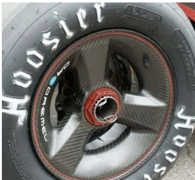
Obrázek 28 disky z uhlíkového kompozitu týmu TU Gratz [20]
