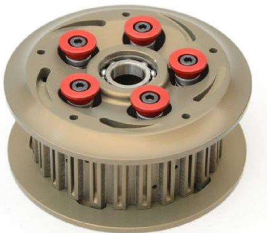
Obrázek 4 vlevo vnější pohled na spojku TSS vpravo detail vnitřní konstrukce antihopíngové spojky, jsou zřetelně vidět kuličky umístěné na rampách které slouží k částečnému vystavení spojky [13;archiv autora]
