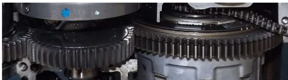
Obrázek 3 Primární převod vpravo je vidět vymezovač mezi zubové vůle [archiv autora]
