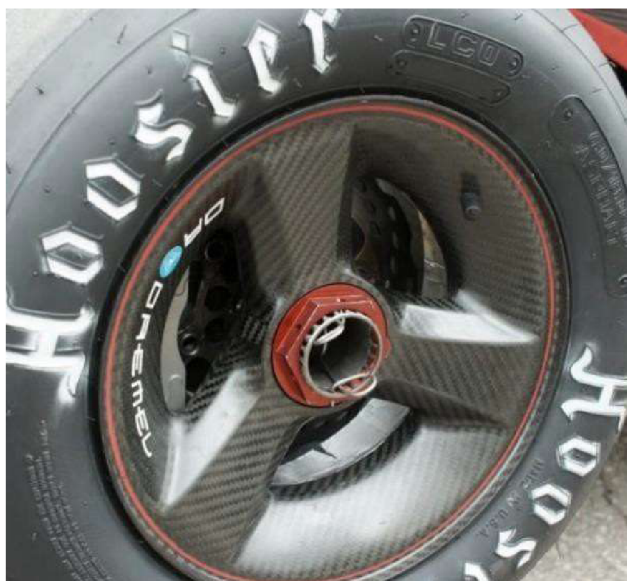
Obrázek 28 disky z uhlíkového kompozitu týmu TU Gratz [20]
