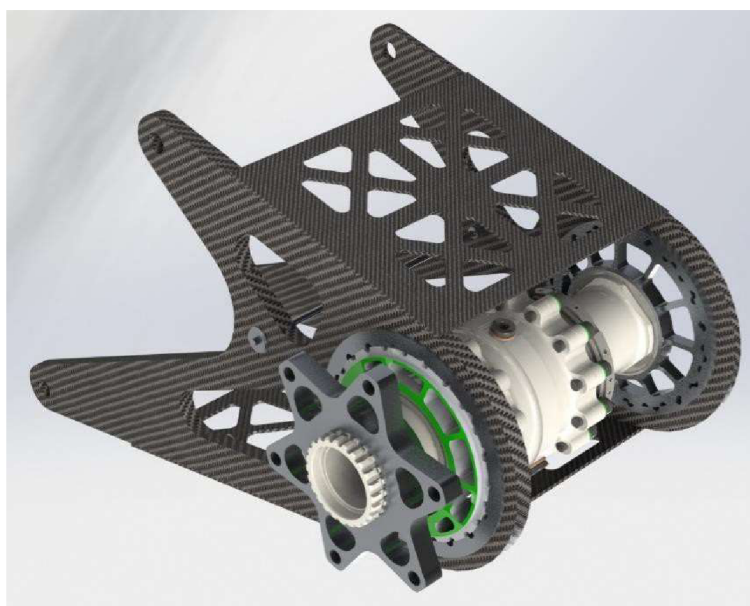
Obrázek 21 podoba výsledného návrhu držáku z uhlíkového kompozitu [archiv autora]
