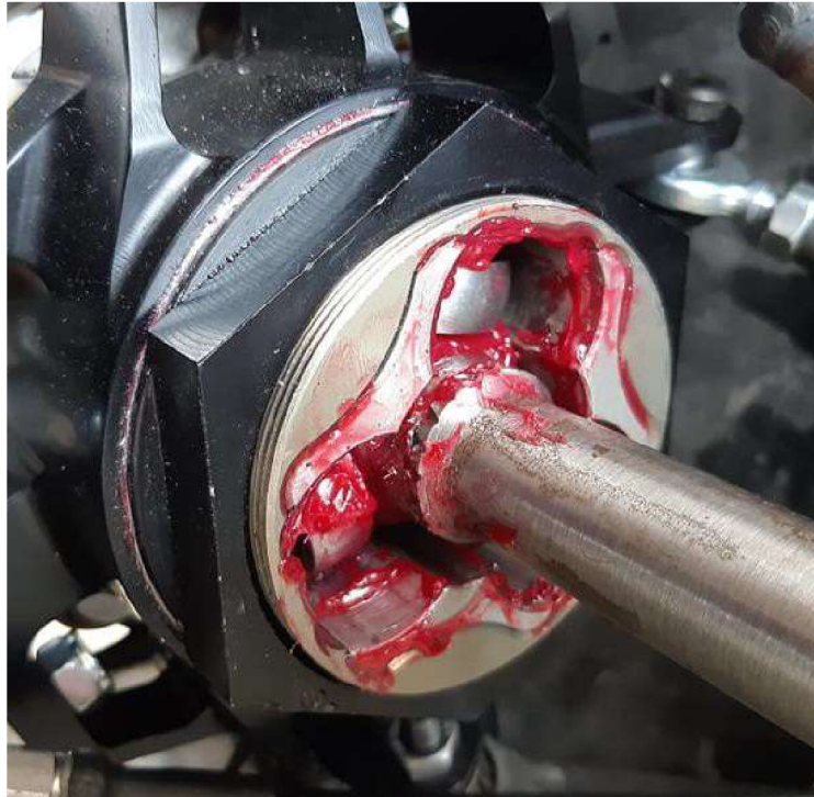
Obrázek 26 kompletní sestava s triopidem na voze FS 6 - všechny díly jsou ale shodné i na FS 7 [archiv autora]
