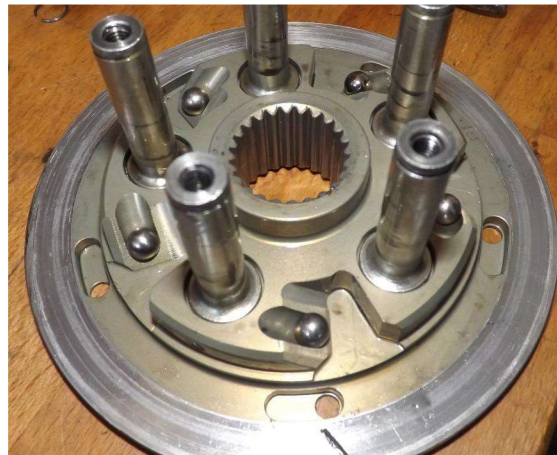
Obrázek 4 vlevo vnější pohled na spojku TSS vpravo detail vnitřní konstrukce antihopíngové spojky, jsou zřetelně vidět kuličky umístěné na rampách které slouží k částečnému vystavení spojky [13;archiv autora]
