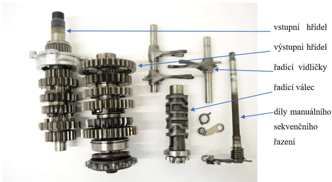
Obrázek 5 jednotlivé díly řazení originální převodovky Triumph 675 [archiv autora]
