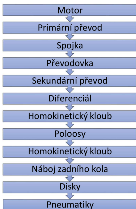
Obrázek 2 Základní schéma přenosu výkonu [archiv autora]
