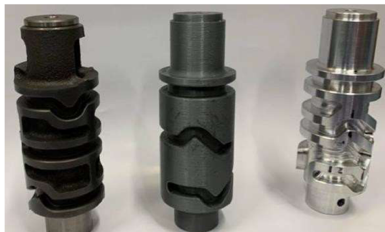
Obrázek 9 porovnání řadicí válců: zleva: originální, 3D tisk pro ověření, díl pro FS 6 [archiv autora]
