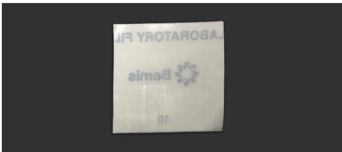
Obr. 25 Orientovaná vlákna z PLGA bez aditiv nanosená na parafilmovém čtverci velikosti 3x3 cm
