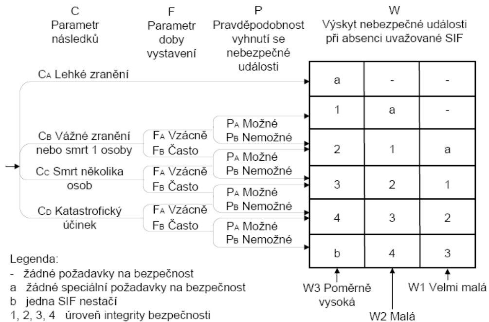
Obr. 11: Schéma určení úrovně SIL dle ČSN EN 61508 [5]
