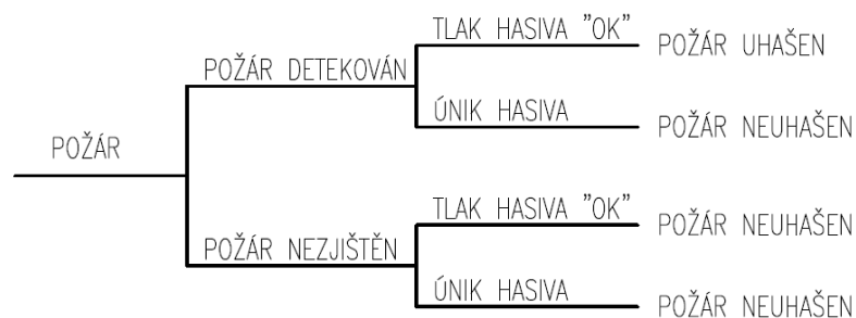
Obr. 21: Příklad stromu událostí pro jednoduchý protipožární systém
