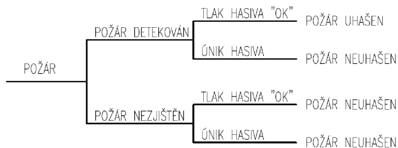
Obr. 21: Příklad stromu událostí pro jednoduchý protipožární systém
