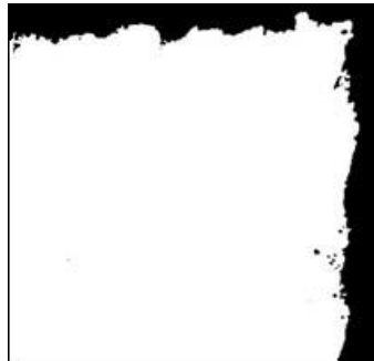
Obr. 12 Zvýraznění impregnované části vzorku (černá) s neproimpregnovanou částí (bílá)
