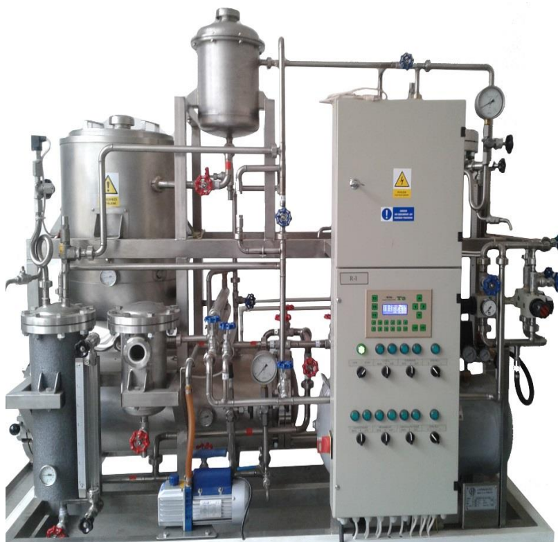
Obr. 11 Vakuově tlaková impregnační linka (Pařil 2016)
