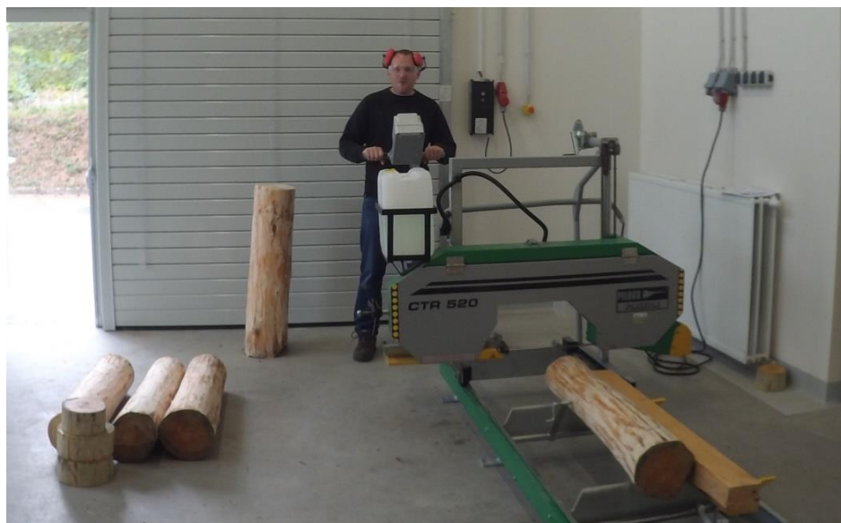
Obr. 9 Rozřezávání jednotlivých výřezů na fošny horizontální pásovou pilou
