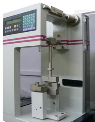
Obr. 27 Zkušební zařízení CeastResil 5.5
