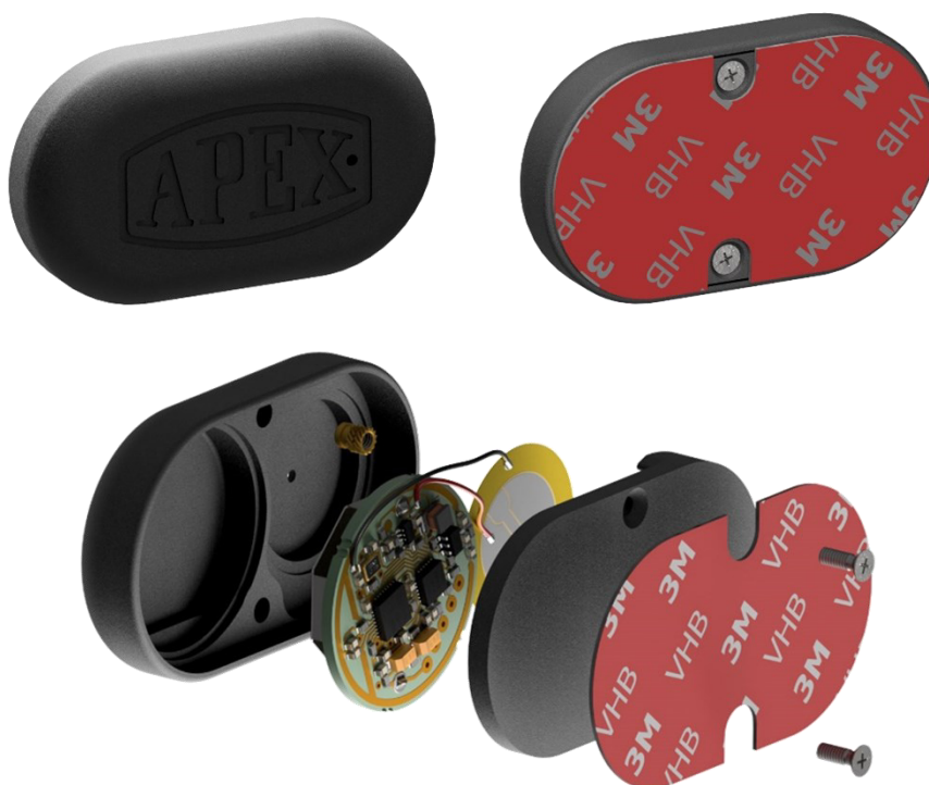
Obrázek 30: Konečný návrh samolepícího pouzdra tagu (Zdroj: vlastní)
