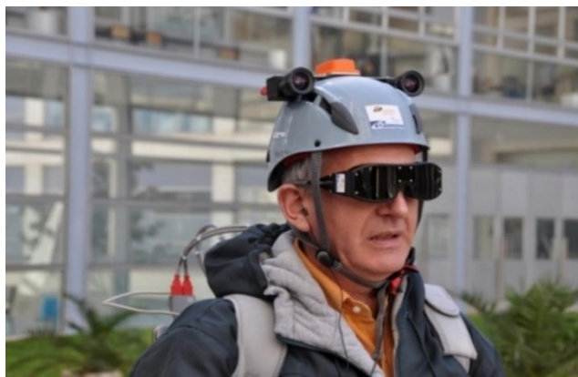
Obrázek 12: Testování kompenzační pomůcky v rámci projektu CasBlip (Zdroj: [26])
