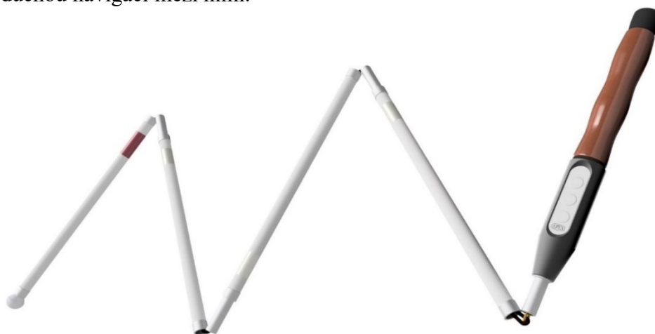
Obrázek 9: Vysílač pro nevidomé VPN03 osazený v rukojeti bílé hole (Zdroj: vlastní)
