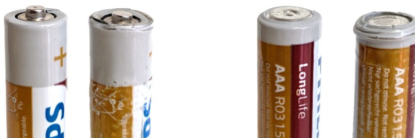
Obrázek 14: Srovnání nové a poškozené AAA baterie, kladný pól vlevo a záporný pól vpravo (Zdroj: vlastní)
