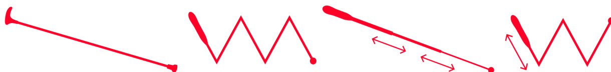
Obrázek 3: Konstrukce bílé hole, zleva: pevná, skládací, teleskopická a kombinovaná (Zdroj: [18])
