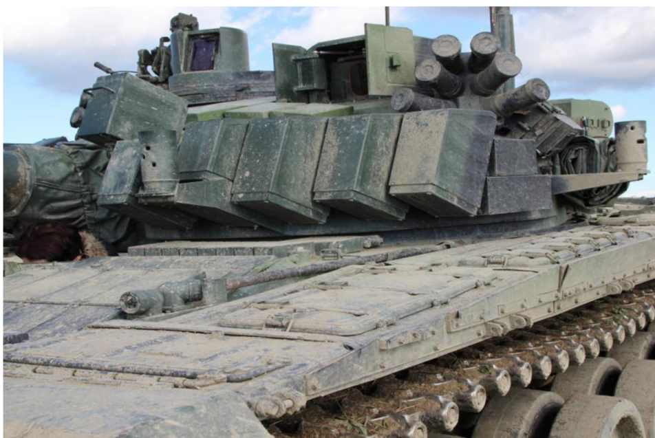
Obr. 20 Reaktivní pancíř systému DYNA-72 na českých tancích T-72 M4 [25]
