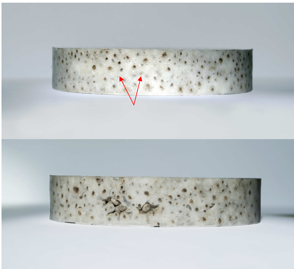
Obr. 8 - Vzorek č. 53 (nahore) bez porušené povrchové struktury a vzorek č. 44 (dole) s porušenou strukturou povrchu
