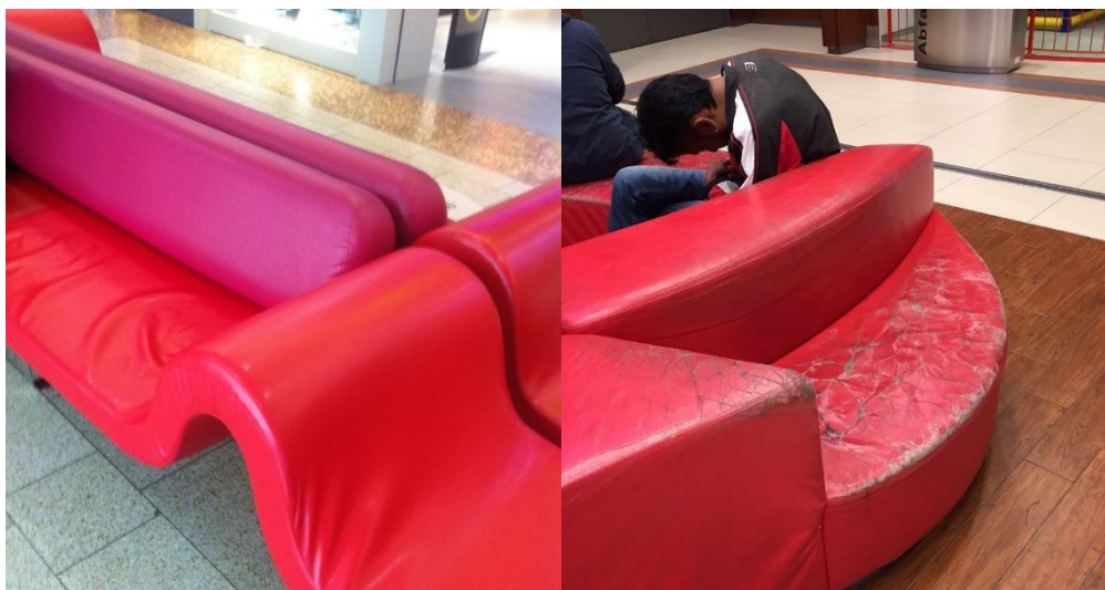
Obr. 69. Poškození koženky – protažení (vlevo), rozlupčivost vrstev, oděr (vpravo)
